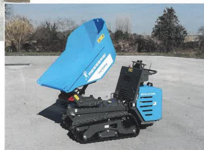
novità Made in Italy con il TC50-e, dove "-e" sta ovviamente a indicare una motorizzazione a batteria. Base di partenza di questo nuovo modello è l'apprezzato trasportatore cingolato TC50, il più piccolo prodotto da Messersì, caratterizzato da un carico utile di 500 kg, una larghezza di 660 mm che facilita l'accesso a spazi stretti e finora proposto con motore a benzina o diesel. Il nuovo TC50-e mantiene queste prestazioni ma
