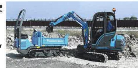
si avvale di un propulsore diesel Kubota da 14 kW e di una trasmissione con pompe a portata variabile.
