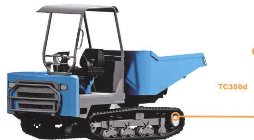
benna a colmo di 1.88 m<sup>3</sup> e con carico utile di 3500 kg. I comandi sono completamente servoassistiti su joystick montati sui braccioli del sedile, che ruota di 180° così da permettere all'operatore di seguire le operazioni di scarico. Un particolare sistema elettroidraulico permette di mantenere la posizione dei joystick sempre nella direzione di marcia scelta dall'operatore. Il nuovo modello monta un motore Kubota turbodiesel Common rail adeguato alla normativa Stage V (43,2
