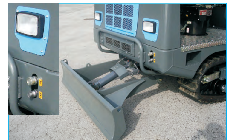
Frontal dozer blade and P.T.O. (options). Planierschild Frontanbau und Zusatzhydraulik (Optionen).
