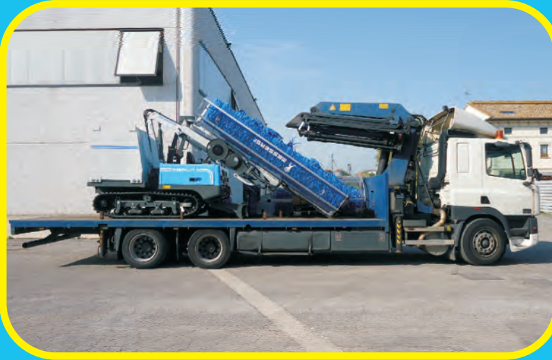
Roboklin 25 on the loading platform in position for transport. Roboklin 25 auf der Ladeplattform in Position für den Transport.
