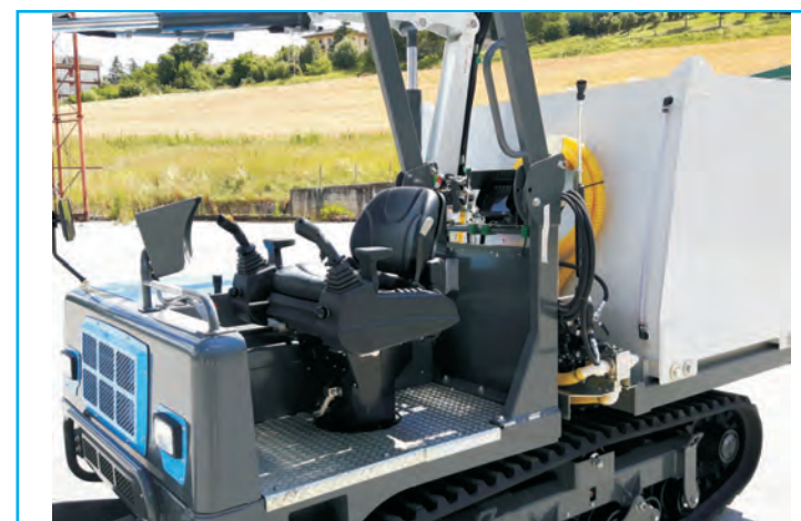
Driving place with the joysticks, the electronic display, the camera for backward driving and water pressure gun. Fahrerstand mit JoyStick, Steuer- und Kontrolleinheit, Rückfahrkamera, Hochdruckreiniger für die manuelle Reinigung.
