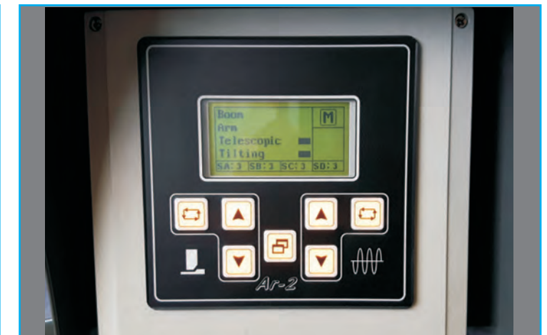
Digit display managing the electronic safety system of the boom movements and the ultrasonic sensors distance. Über die automatische Steuerung werden der Abstand zur Solar-Paneele, der Winkel usw. eingestellt und überwacht.
