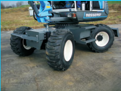
Tre diversi tipi di sterzatura standard: 2 ruote, 4 ruote e "a granchio". - Trois différent systèmes de braquage standard: 2 roues, 4 roues et en crabe.
