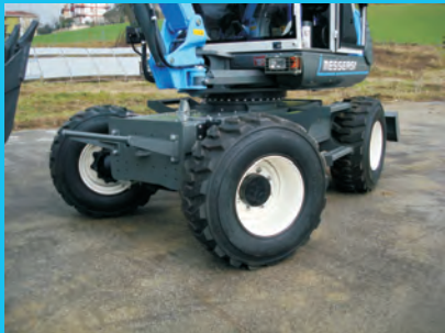
Tre diversi tipi di sterzatura standard: 2 ruote, 4 ruote e "a granchio". - Trois différent systèmes de braquage standard: 2 roues, 4 roues et en crabe.
