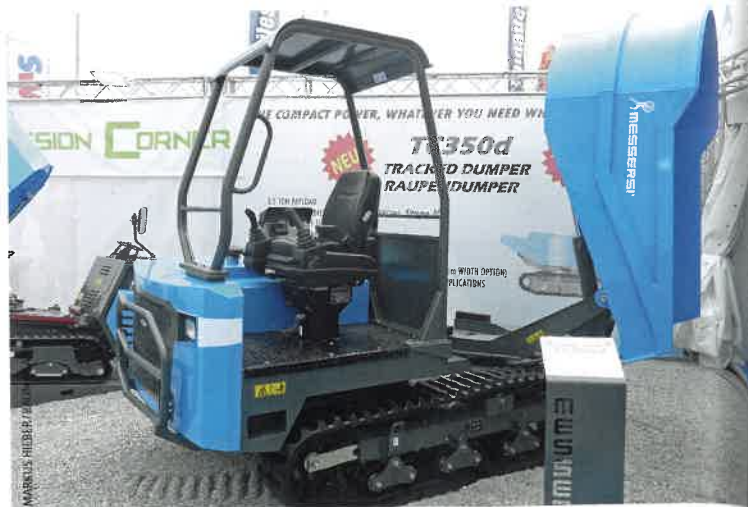
Der neue TC350d ist der bisher größte Raupendumper von Messersi. In München war er mit einem Schutzdach sowie einer Drehschüttmulde zu sehen.
