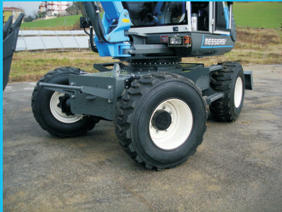
Three different steering selections as a standard: 2 or 4 wheel steering and "crab". Drei verschiedene Lenkerten: Zweirad- sowie Vierradlenkung und "Krebstgang".
