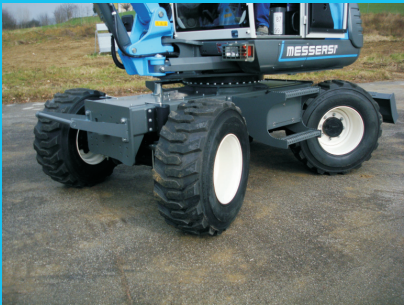
Three different steering selections as a standard: 2 or 4 wheel steering and "crab". Drei verschiedene Lenkerten: Zweirad- sowie Vierradlenkung und "Krebstgang".
