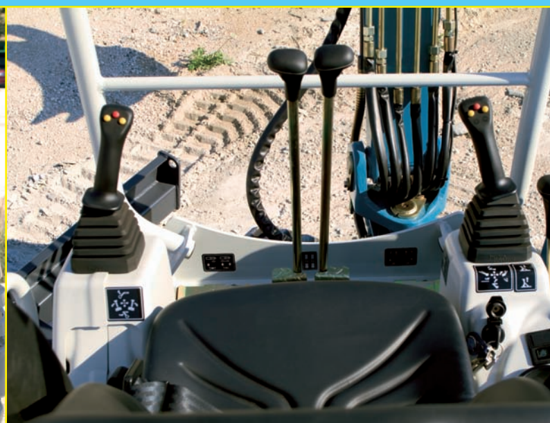
Driving place with servo-controls joystick / Fahrersitz mit Joystick Hebel für die Steuerung und Lenkung / Гпейужмэтлпж нжтп т эзпктуылпн фрбсгмжой нбожсйспгой
